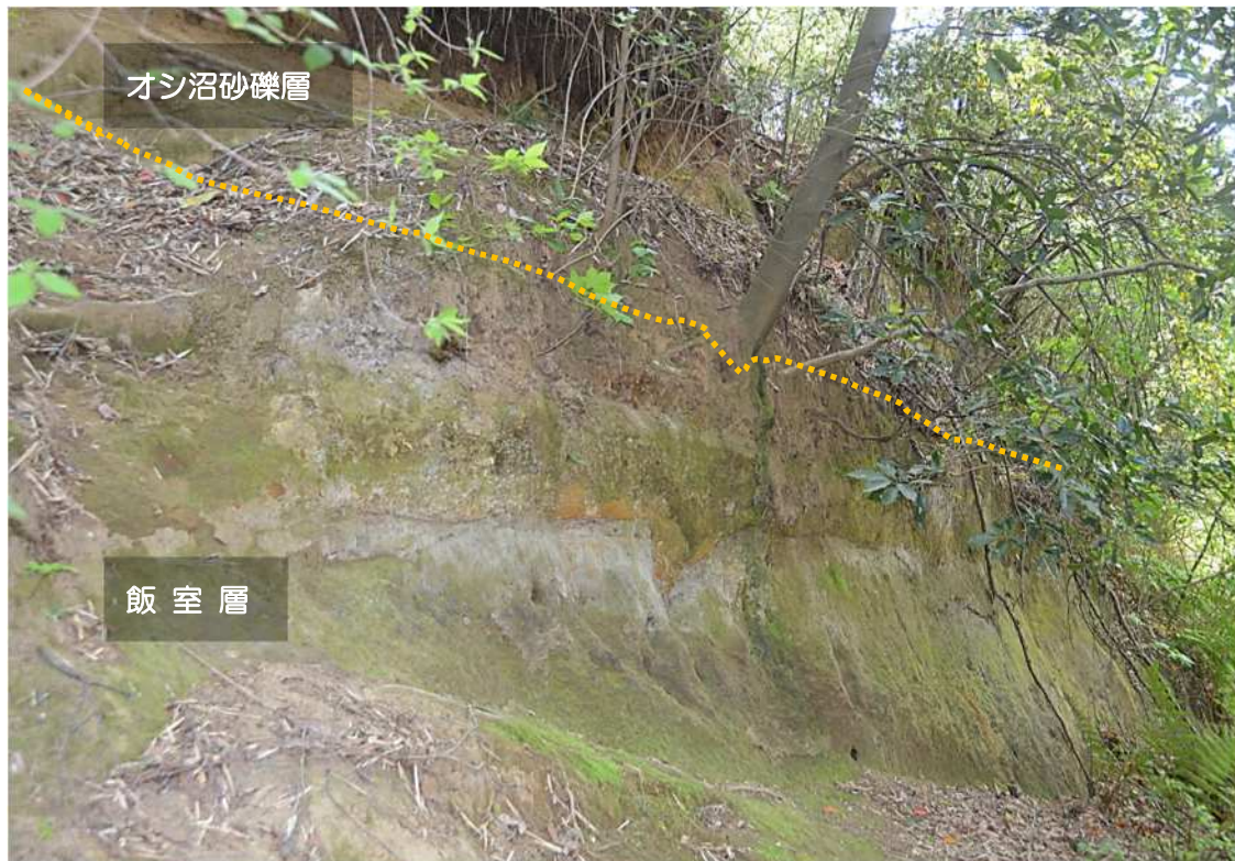
写真 36 露頭⑨ (飯室層とオシ沼砂礫層の不整合面)
