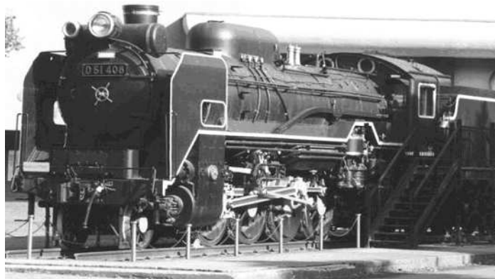
（最大 1,200 馬力、全長 19.5 m、高さ 3.9 m、幅 2.8 m、機関車空車 70 t、炭水車空車 19 t）
