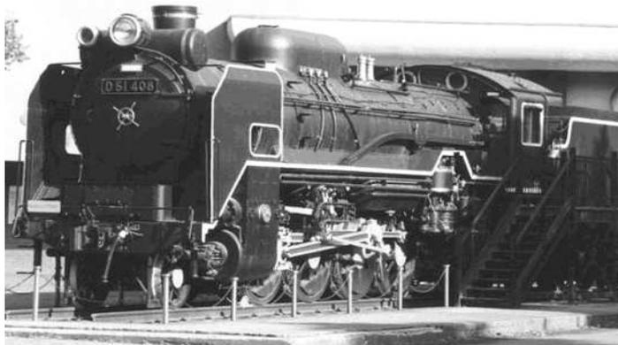
(最大 1,200 馬力、全長 19.5 m、高さ 3.9 m、幅 2.8 m、機関車空車 70 t、炭水車空車 19 t)
