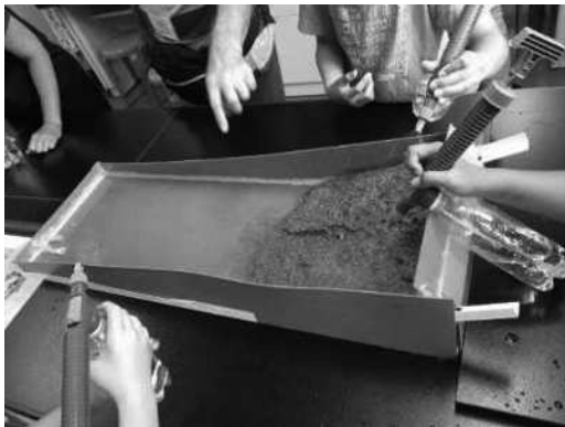
図 4. 模型水路による地形の変化を実験
