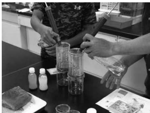
図2. 飯室泥岩層・おし沼砂礫層の水はけ実験
