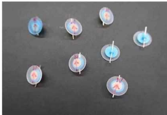
図 5. 水に沈んでも極方向に向く方位磁針
