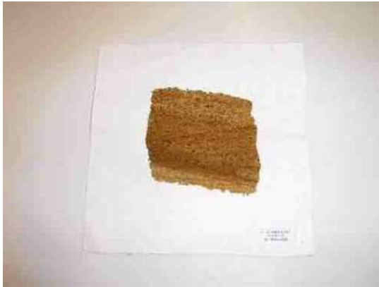
図 3. おし沼砂礫層の剥ぎ取り試料
