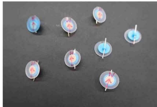
図 5. 水に沈んでも極方向に向く方位磁針
