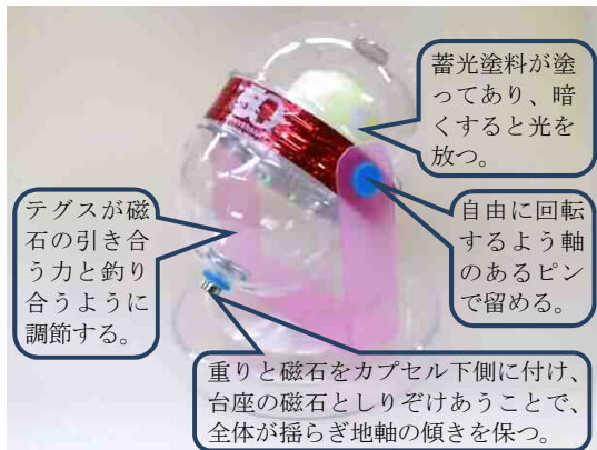
図 3. 磁石のはたらきで浮かぶ惑星
