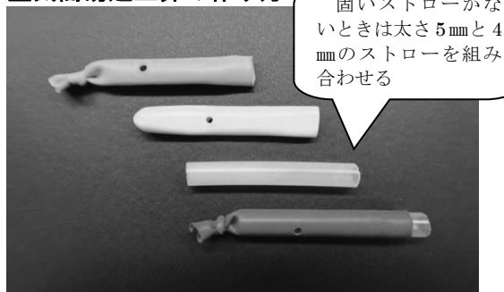
図1. バルーンアート用風船に穴を明け、直径6mmストローを通した空気簡易逆止弁
