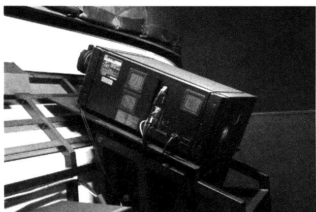
ドーム北側と南側の水平線位置から、ビクター製 D L A-SH 7 N L 投影機 2 台により投影している。そのため
