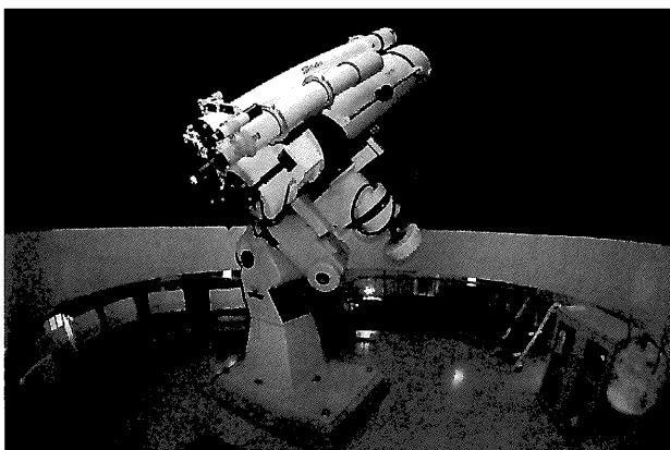
設置から30年が経過し、光学系・電気回路等の部品が劣化したため、全て分解し反射鏡の再メッキ、電子回路及び配線の交換、プロミネン望遠鏡を15cm屈折望遠鏡に交換、主焦点撮影アタッチメントの交換、鏡筒及び赤道儀の再塗装を実施した。この改修により、系外銀河の超新星観測、太陽系外惑星の観測、地球に接近する特異小惑星の観測、木星閃光現象の観測等が可能となった。
