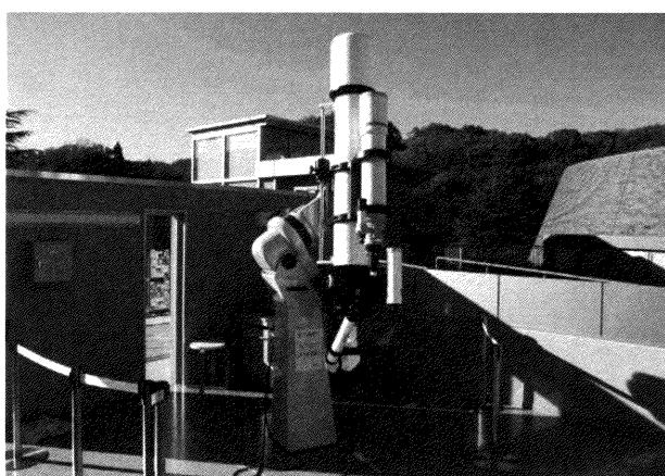
昼間でも5等星までの恒星を確認し、色の違いが観察できる低分散ガラス素材を使用した高精度の対物レンズ。対物レンズから接眼部までの光路に、星像を劣化させる反射ガラス等を使用しない屈折式鏡筒。車椅子の方や子どもでも観察しやすい、バリアフリー設計の接眼部が装着可能である。
