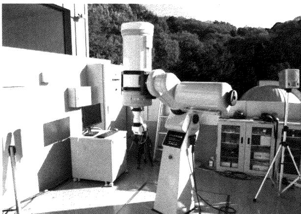
反射望遠鏡は、熱膨張率の低いガラス素材で高精度の反射鏡を使用したカセグレン式鏡筒を採用した。車椅子の方や子どもでも観察しやすい、バリアフリー設計の接眼部が装着可能である。
