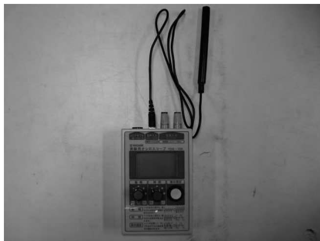
図1. 実験用オシロスコープ YDS-10K（ヤガミ製）。
