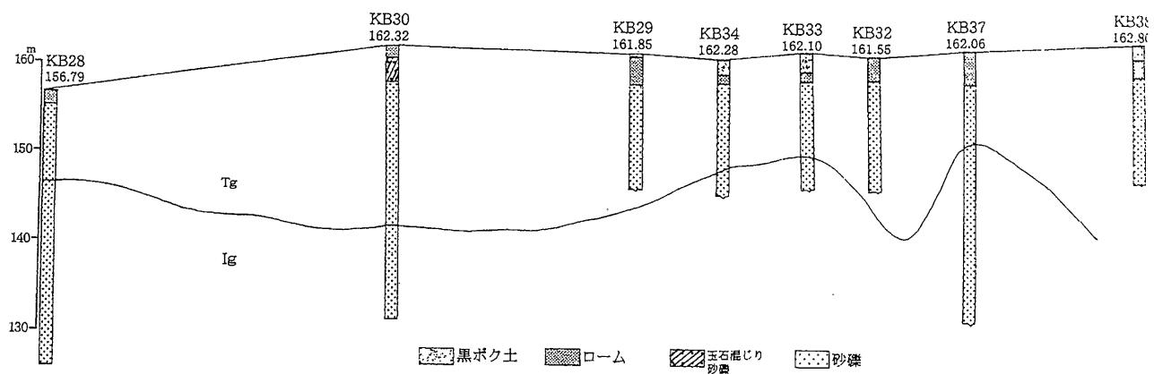
図6 圏央道ボーリング地質断面図
