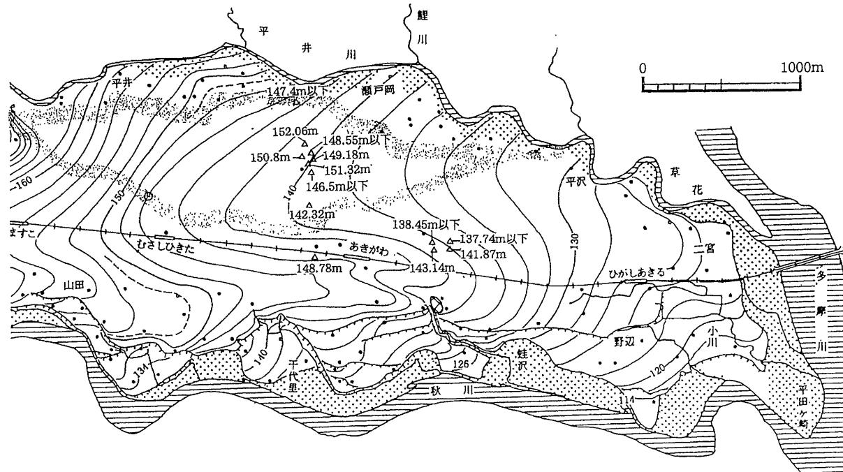
△印は立川礫層基底深度（角田1981　自由地下水水面等高線図を使用）
